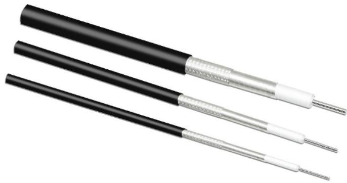
目前，常用的射频同轴电缆有两类： $50\Omega$ 和 $75\Omega$ 的射频同轴电缆。特性阻抗 $75\Omega$ 射频同轴电缆常用于**CATV**网，故称为**CATV**电缆，传输带宽可达 $1\text{GHz}$ 。目前常用**CATV**电缆的传输带宽为 $750\text{MHz}$ 。**RG**射频同轴电缆/**JIS**射频同轴电缆/**SYV**射频同轴电缆的优势：高纯度(**OFC**)无氧铜导体，进口实芯聚乙烯绝缘，耐磨，抗腐蚀性强的聚氯乙烯护套，长期工作额定温度为 $70^\circ\text{C}$ 。**RG**同轴电缆/**JIS**同轴电缆/**SYV**同轴电缆主要用于智能建筑中的安防监控系统(**CCTV**)。如供摄像头与监视屏之间的连接，传输视频信号，所以之间的连接线通常又称为视频线。**RG**同轴电缆符合美车国家用标准**MIL-17G**，使用频率达 $100\text{MHz}$ 。
